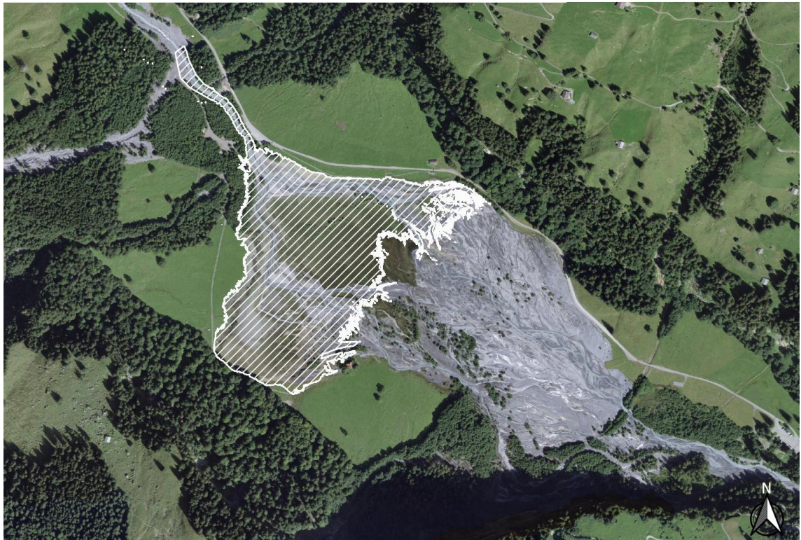
Abbildung 10: Aufstauungssituation Sommer 2024 nach Murgangereignis am Ärmiggraben.
